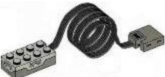
ДАТЧИК НАКЛОНА                            |
